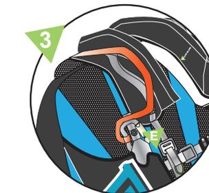
3. Bien vérifier que la sangle de connexion (B) ne fait pas de twist ou ne tourne pas autour des élévateurs de connexion voile de BASE-sellette (C).
