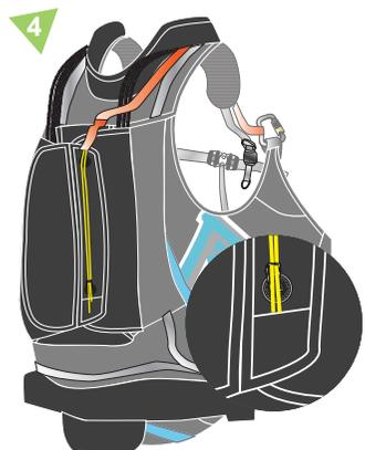
4. Répéter l'opération 3 avec la cordelette (loop) du volet inférieur. Placer les extrémités des câbles dans le cache prévu à cet effet.
