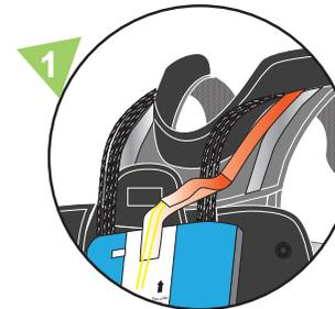
1. Placer le pod de façon correcte (logo «this side up» avec flèche vers le haut). Faire sortir la sangle de connexion du pod et la placer au dessus des élévateurs de connexion voile de BASE. Vérifier qu'il n'y a aucun twist et que la sangle de tourne pas autour de ces élévateurs.
