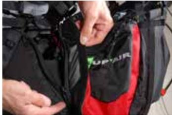
Demontiere die rechte oder linke Seitentasche von dem Gurtzeug, indem du komplett den Reißverschluss öffnest.
