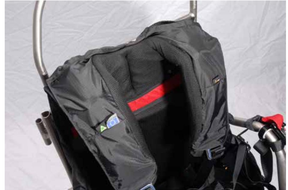
Ist der Rettereinbau abgeschlossen, führe eine Retterauslöse durch, während einer Sitzprobe in einer Gurtzeugaufhängung, um die einwandfreie Kompatibilität zu prüfen, bevor genau der selbe Rettereinbau wiederholt wird...
