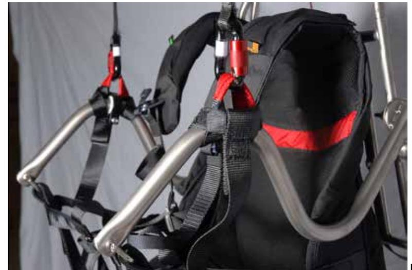
Gurtzeugverbindung mit tiefen Schubstangen, die am Anfang gerade und am Ende nach oben gebogenen sind.
