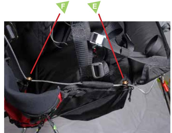
Fädle die Leine durch die Beschleunigerrolle E, durch den Stoffschlauch und dann durch die Rolle F.
