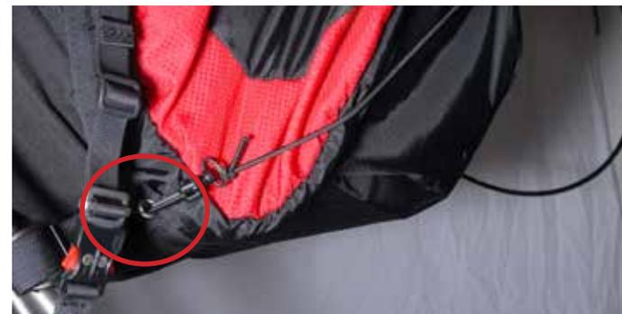
Hake den Rückholgummi in die Öse, die sich an der äußeren hinteren Seite des Gurtzeugs befindet.
