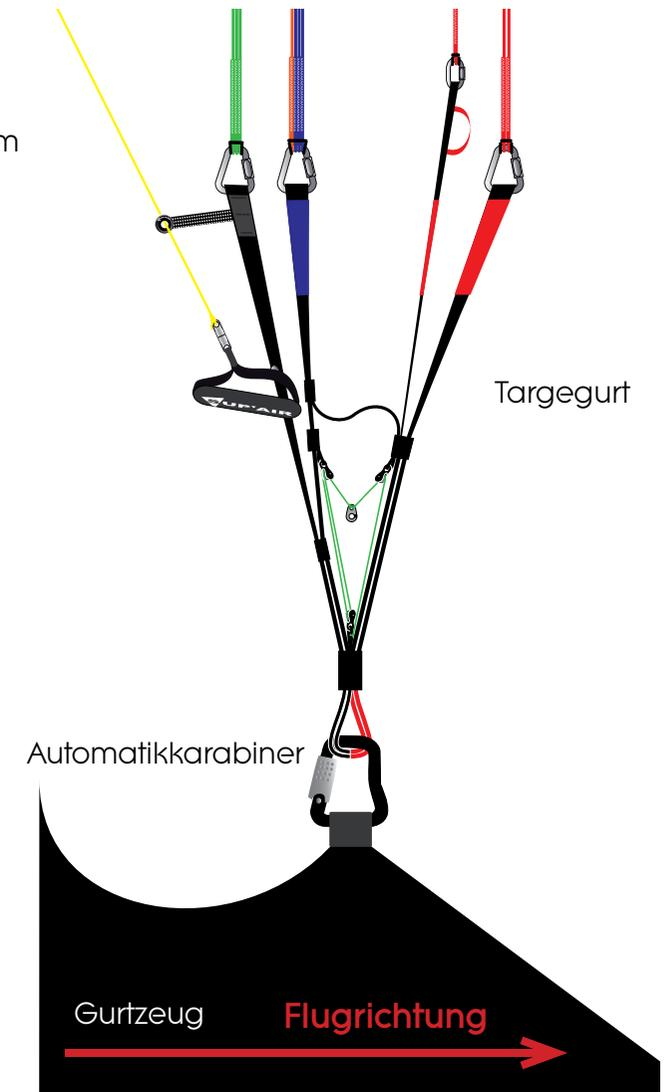
Das PARAMOTEUR EVO Gurtzeug passt zu den meisten auf dem Markt heute erhältlichen PARAMOTEURRahmen. Das Gurtzeug ist mit zwei oberen und zwei unteren Befestigungspunkten und zusätzlich mit zwei diagonalen Gurten ausgestattet.
