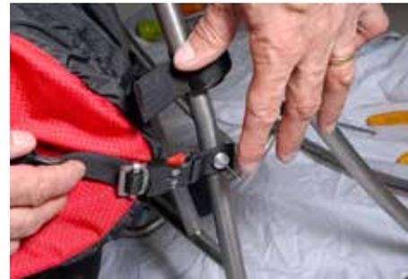
L'extrémité de la sangle est à fixer par un rivet POP sur le châssis.
