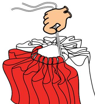
**4.** Utiliser la drisse placée pour mettre le parachute en tension. Dégager les deux suspentes extérieures sur l'élévateur.
