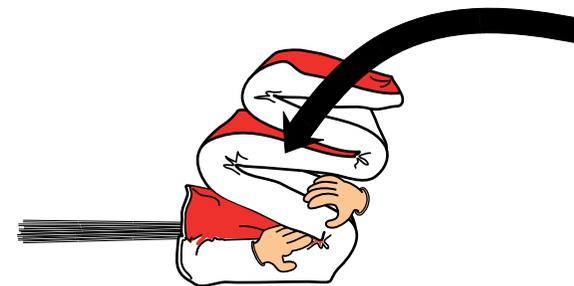
12. Poser le pod par dessus, puis retourner le tout en ménageant un petit espace en avant du bord d'attaque pour le lovage ultérieur des suspentes.
