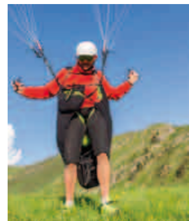
Jean-Michel Ara-Somohano au gonflage. Structure en sangles Dyneema 12 mm, cuissarde droite cousue pour éviter les oublis d'accrochage.
