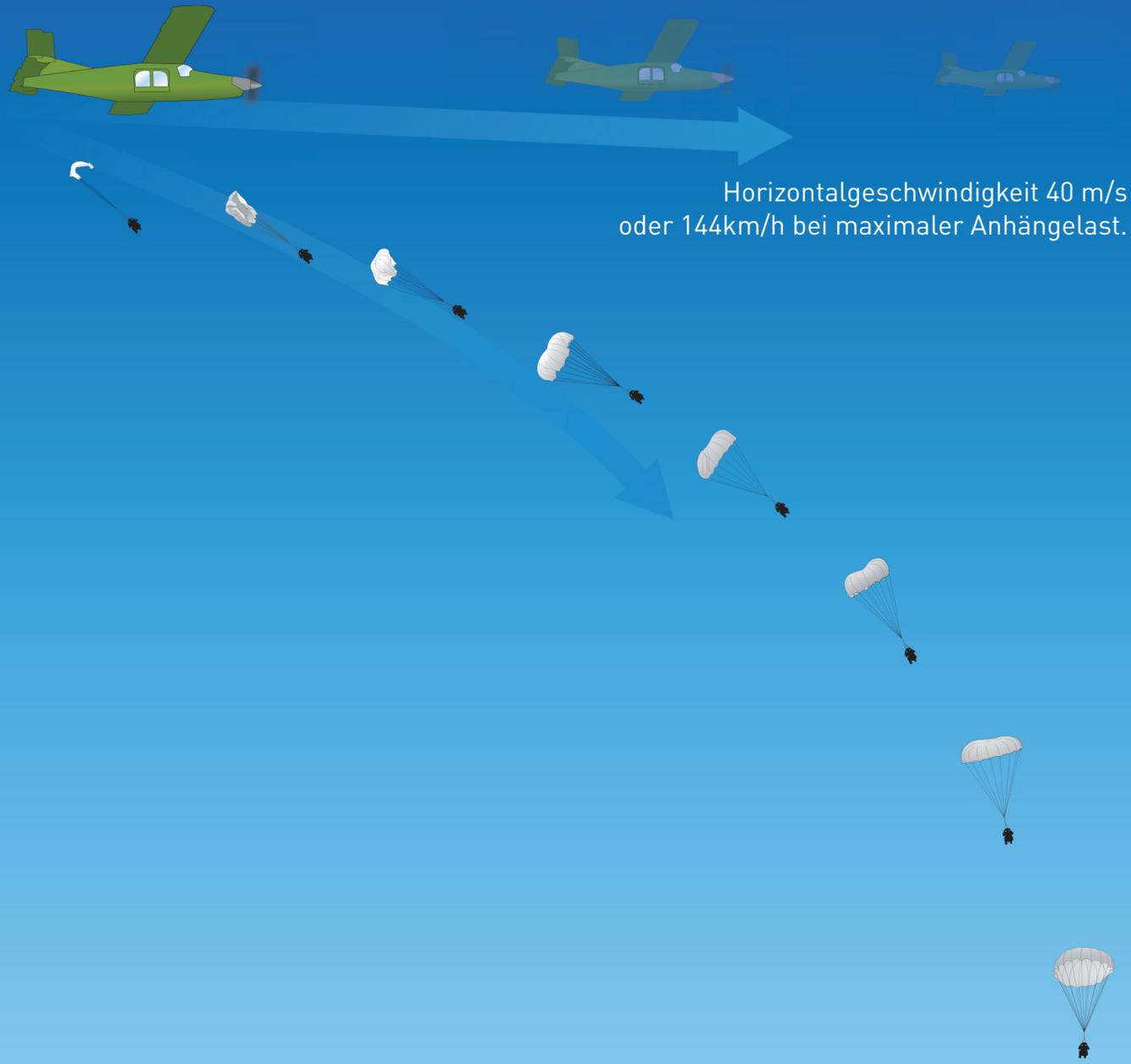
Belastungstest (Festigkeit) : Beinhaltet die Prüfung, dass die unversehrte Gesamtstruktur des Rettungsgeräts unter maximaler Anhängelast auf eine horizontale Geschwindigkeit 32m/s gebracht wird. Da dürfen kein Versagen / Beschädigung bei den Tragegurten / Leinen / Schirm / Absturz während des Öffnungsvorgang entstehen.
