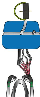
Si vous avez un parachute volumineux et que vous sentez un peu de résistance lors du test d'extraction, attachez la poignée sur la boucle du côté.
