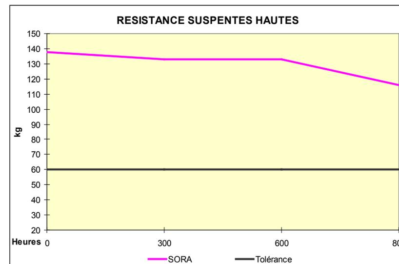
La résistance constatée sur les suspentes hautes tout au long de la vie d'une voile reste très largement supérieure aux exigences de sécurité. Même après 800 heures, le suspentage de notre échantillon offrait une résistance de plus du double de la tolérance minimum (120kg contre 60kg).
