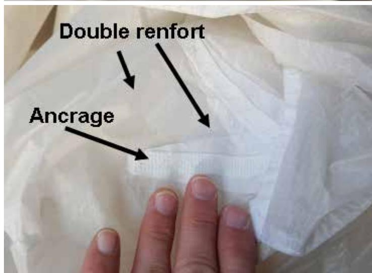
Les points d'ancrage des suspentes ont aussi été largement dimensionnés pour assurer la stabilité structurale de la voile dans le temps. Ils sont complétés par un double renfort sur la nervure.
