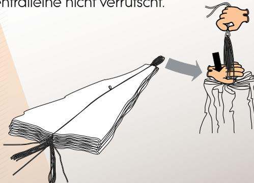
**4.a.** Fädle eine Leine in Reihenfolge durch die Packschlaufen, die mittig auf den Bahnnähten sind, die die ausgewogene Stelle zwischen Mittelleine und Fangleinen bildet.
