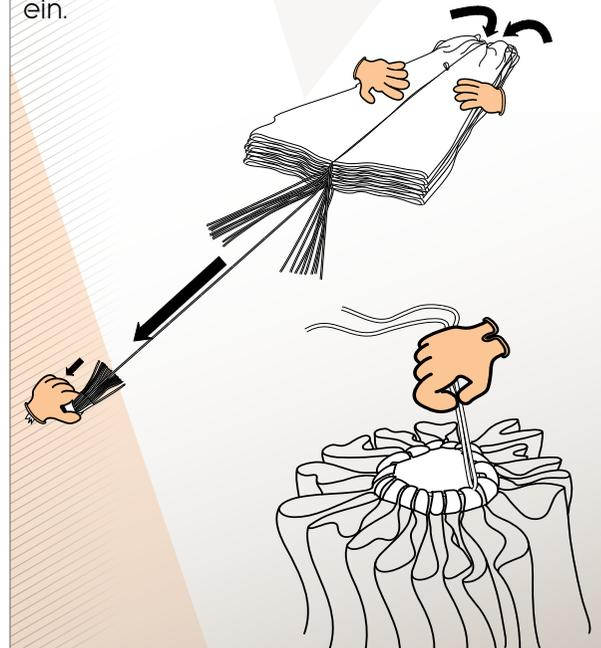
5. Sondere die beiden äußersten Leinen auf dem Tragegurt ab und lege die Leinen in der richtigen Reihenfolge in den Kamm. Lege dann die rechten Bahnen eine nach der anderen sauber aus. Die erste (unterste) Bahn rechts ist die Bahn mit der größten Ziffer.
