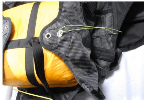
Fädle die Packhilfe bzw. Leine durch die rechte Schlaufe ( falls der Griff rechts montiert wird ).
