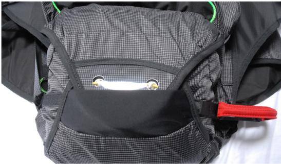
Das gelbe Kabel verriegelt die Containerblätter des Notschirmfachs. Kontrolliere das gelbe Kabel vor jedem Flug, damit es ordnungsgemäß durch die beiden Schlaufen läuft und den Rettungsgerätecontainer sichert.
