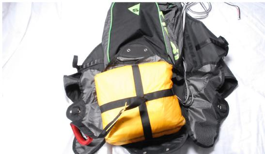
Öffne alle Containerblätter und lege das Rettungsgerät mit dessen Innencontainer hinein. Positioniere den Innencontainer mit dem Rettungsgriff nach oben und die Verbindungsleinen mit Fangleinen nach unten. Lege die Verbindungsleinen in dessen Führung.
