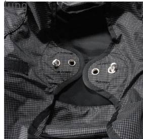
Ziehe auf der Rückseite des Containerblatts, die kleinen Schlaufen aus den Ösen.
